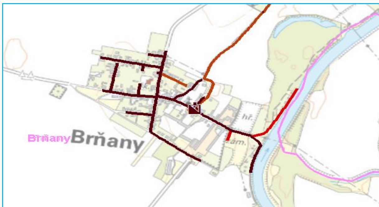
Obrázek 9 Kanalizační síť v obci Brňany
